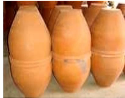
**Gambar 21.** Jeding-jeding ukuran menengah setelah proses pembakaran.
