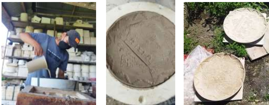
Gambar 33. Foto pada saat proses pengecoran
