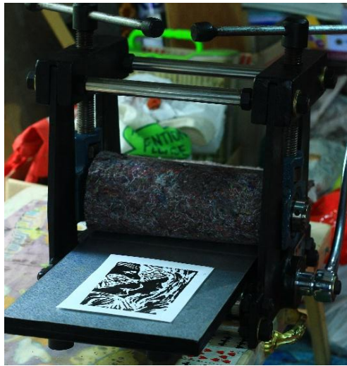
Gambar 2. Mesin cetak grafis format kecil, sebagai salah satu mesin untuk mencetak karya cetak tinggi Sumber: Sigit Purnomo Adi
